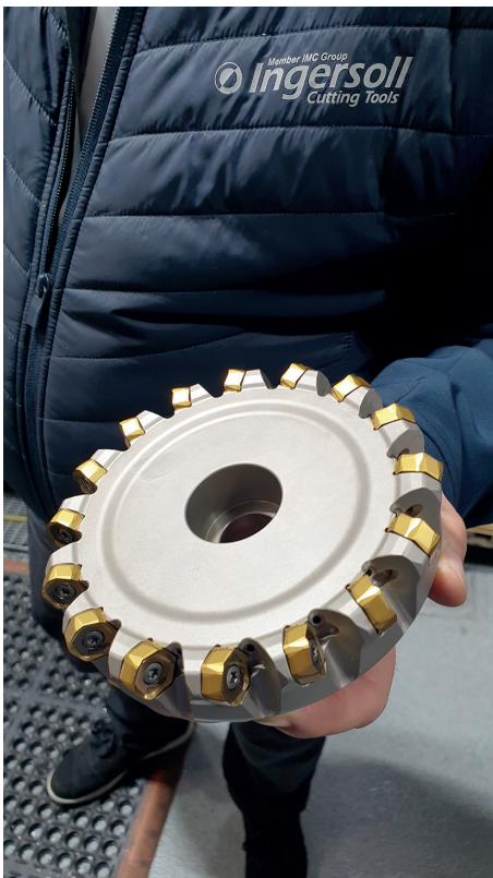
Gussbauteile für den Getriebebau sowie für den Maschinen- und Anlagenbau werden bei Schermer ebenfalls mit dem DiPosHexa Planfräser und HNGU-Wendeschneidplatten bearbeitet
