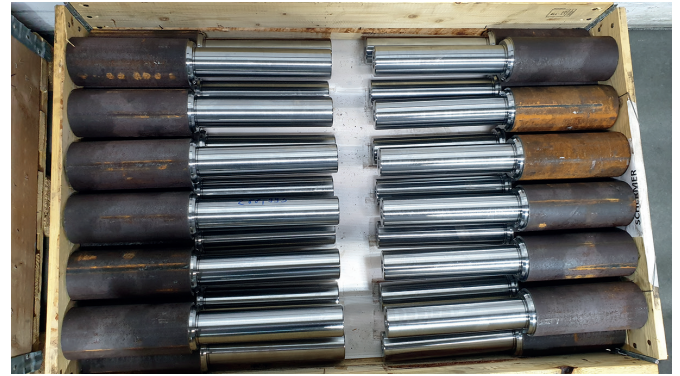
Für den Maschinenbau kann Schermer auch Wellen mit hochgenauen Lagersitzen bis zu einer Länge von 1250 mm bearbeiten
